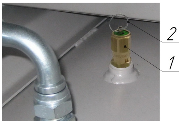
Рисунок 10 – Клапан предохранительный пружинного типа
